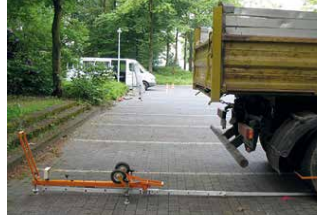
links: Benkelman-Balken, rechts: Asphalt-Flächenheizer
